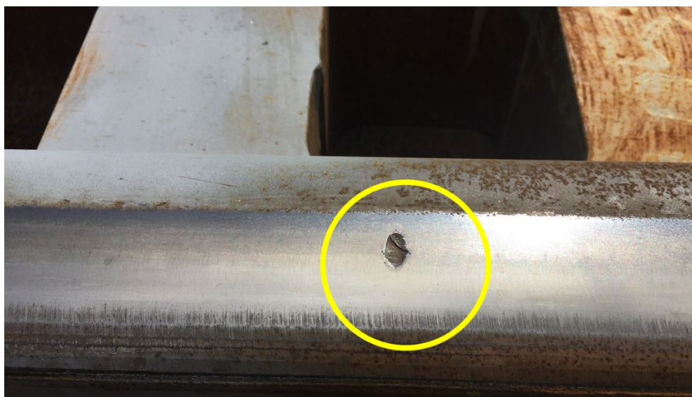
Obrázek 17 – Kontaktně únavové vady v kořeni srdcovky s PHS
