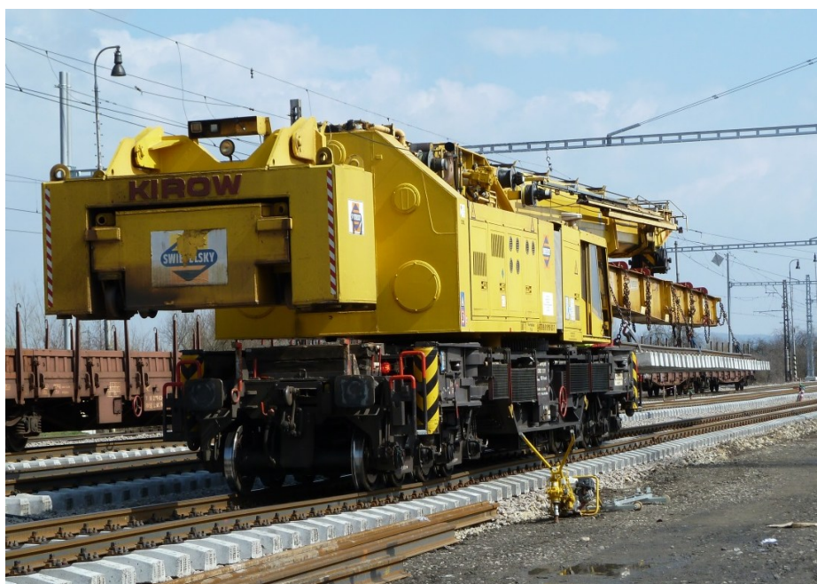
Obrázek 13 – Vhodný kladecí prostředek – pokladač DESEC nebo kolejový jeřáb
